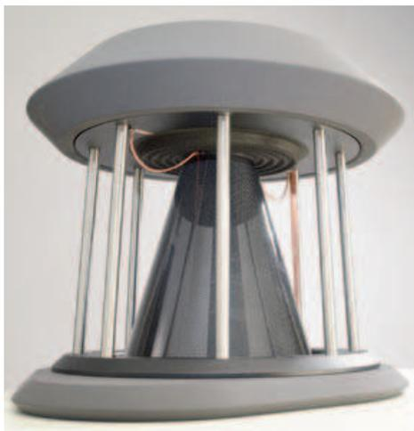
Einzigartige Form: Seitlich strahlt der Biege-wellenschwinger alle Frequenzen über 150 Hertz ab, darunter arbeitet er mit Kolbenhub in die Tiefe einer Basshorn-Konstruktion.
