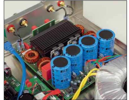
Die kräftige P6 Endstufe ist komplett passiv gekühlt, so dass kein Lüfter eingesetzt werden muss
